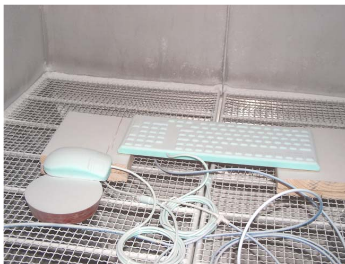
Bild 2: Prüflinge in der Staubkammer
