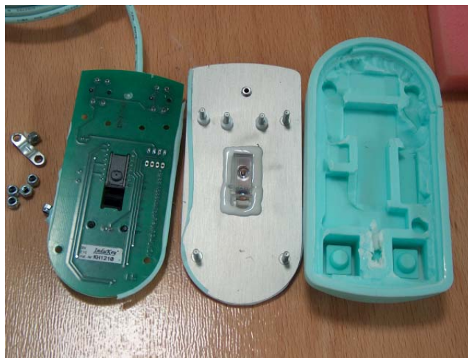
Bild 4: Geöffneter Prüfling Indumouse II
